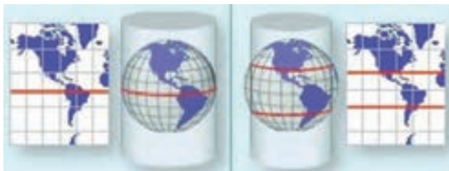
شکل ۳- سیستم مرکاتور مماسی و متقاطع
